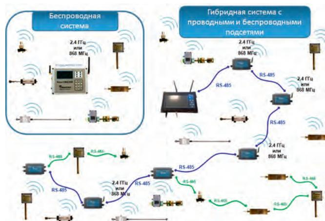
Рис. 6. Структура беспроводной гибридной систем геомеханической и конструкционной безопасности
