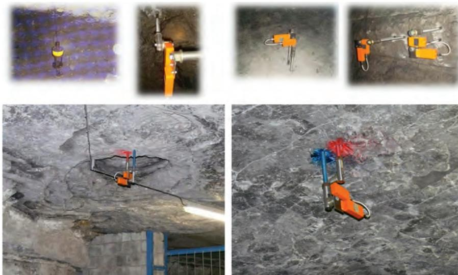
**Рис. 1. Мониторинг состояния подземных выработок и контроля состояния кровли Шахты ОАО «Кнауф Гипс Новомосковский»**
