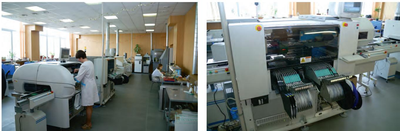
**Рис. 5. Производственная линия автоматического поверхностного монтажа печатных плат (слева) и входящий в ее состав роботизированный установщик электронных компонентов (справа)**
