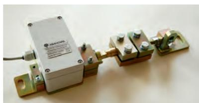
Рис. 4. Индукционный датчик перемещения СМД-ДП-2
