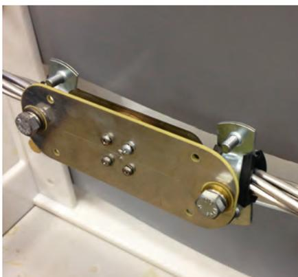
Рисунок 7. Датчик ТЕРМО-Н, установленный на провод ЛЭП
