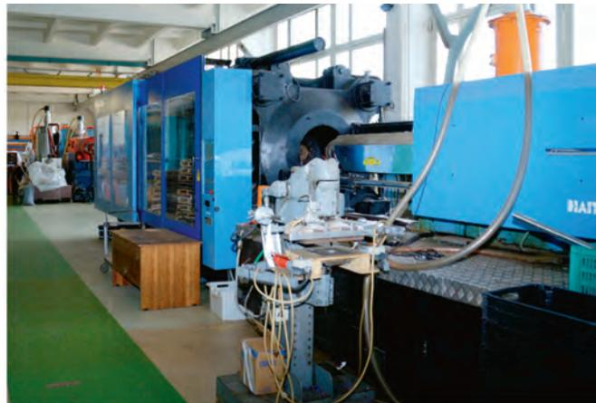
**Рис. 6. ОТК предприятия (слева) и цех литьевых машин для пластмассовых изделий (справа)**
