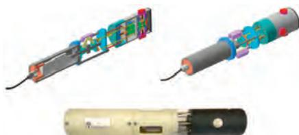
Рис. 4. Трехкомпонентный датчик перемещений
