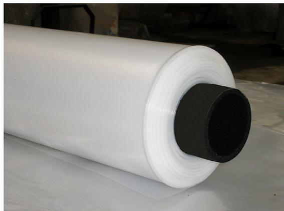
**Светостабилизированная пленка** содержит в составе светостабилизаторы, которые уменьшают воздействие УФ лучей и позволяют использовать пленку при нормальном режиме эксплуатации не менее 3 лет. Применяется для укрытия парников и теплиц. Изготавливается с применением стойких и безопасных красителей и может быть окрашена в любой цвет. Диапазон толщины – 100 – 200 мкм.
