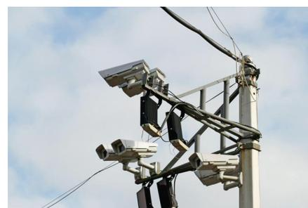
**Рис. 6** Система автоматической фотовидеофиксации «Интегра-КДД»
