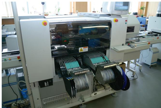
**Рис. 5. Производственная линия автоматического поверхностного монтажа печатных плат (слева) и входящий в ее состав роботизированный установщик электронных компонентов (справа)**
