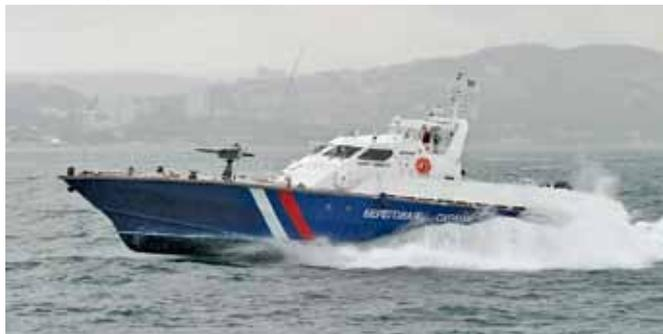
El sistema de interceptores con control automático de dirección permite al barco alcanzar la velocidad de hasta 48 nudos y reducir significativamente la amplitud del balanceo de a bordo en los mares agitados y asegura el uso de armas con oleaje de hasta 3 grados, y la navegabilidad de hasta 5 grados. El desplazamiento completo de la lancha es 60,6 toneladas, siendo 30 metros de longitud, 5,8 metros de ancho, con 1,34 metros de calado
